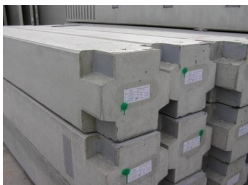
Obr. 4.55 Detail úpravy sloupu v patě
