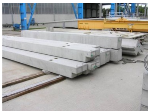
Obr. 4.56 Příklad prefabrikovaných ztužidel
