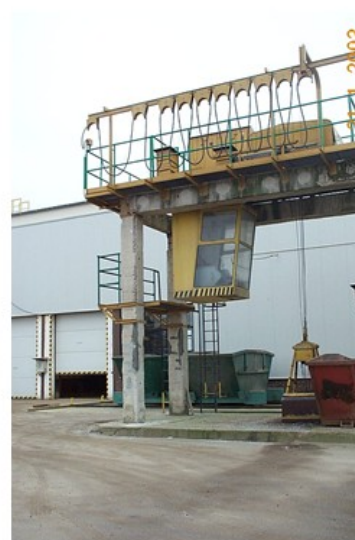
Obr. 4.57 Příklad rámové konstrukce pro jeřáb s drapákem
