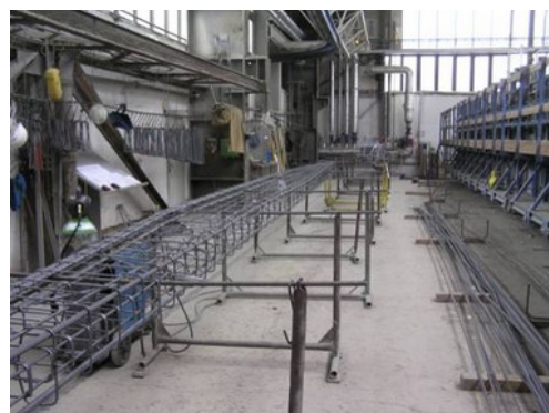
Obr. 4.76 Příklad výroby a vyztužení vazníku
