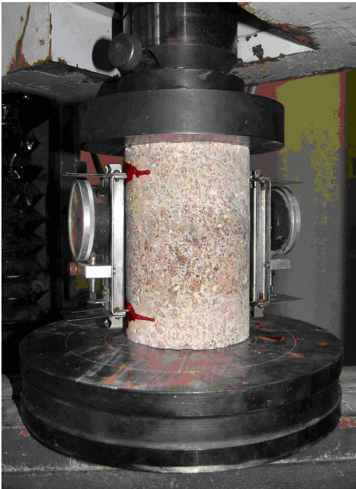
Obr. 3.14 Vzorek z jádrových vrtů v laboratoři
