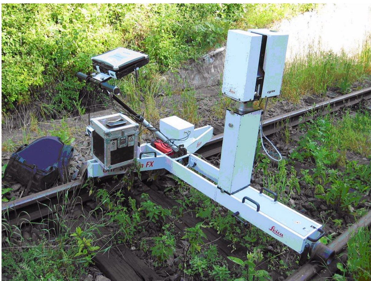
Obr. 3.3 Rotační 3D scanner s plynulým pojezdem (Amberg Technologies)
