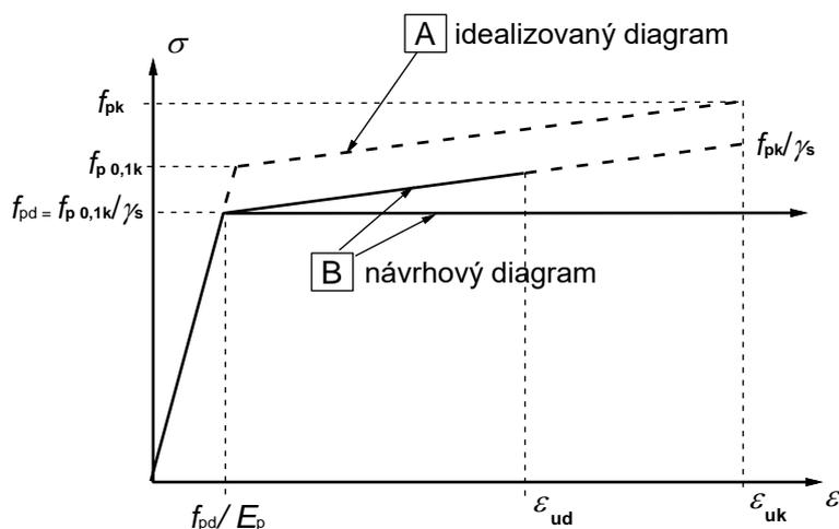
Návrhová hodnota napětí v předpínací výztuži  $f_{pd}$  se vypočítá dle vztahu  $f_{pd} = f_{p0,1k}/\gamma_s$ , kde pro trvalé a dočasné návrhové situace  $\gamma_s = 1,15$ .
