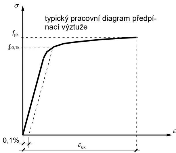
Návrhovou hodnotu **modulu pružnosti  $E_p$**  pro **dráty a tyče** lze předpokládat rovnou 205 GPa. Skutečná hodnota může být v rozsahu 195 GPa až 210 GPa v závislosti na výrobním postupu. V průvodním certifikátu dodávky má být uvedena příslušná hodnota.
